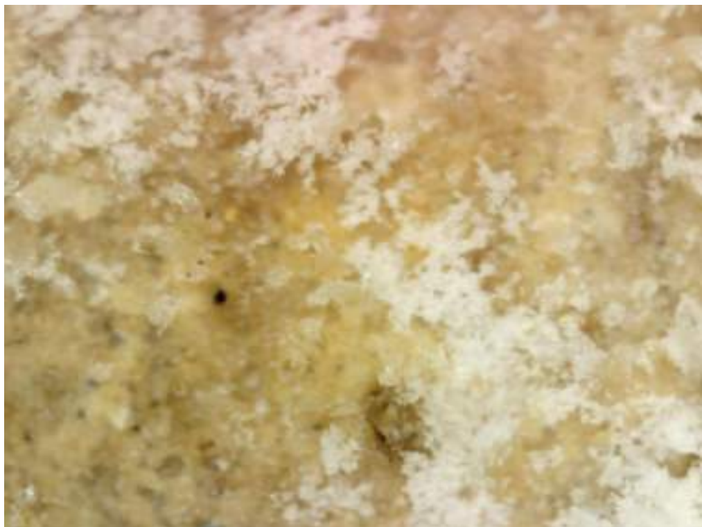
Makro fotografija Pav. Nr. 1 Tapybos dažo užpildo struktūra. Didinimas 200 kartų
